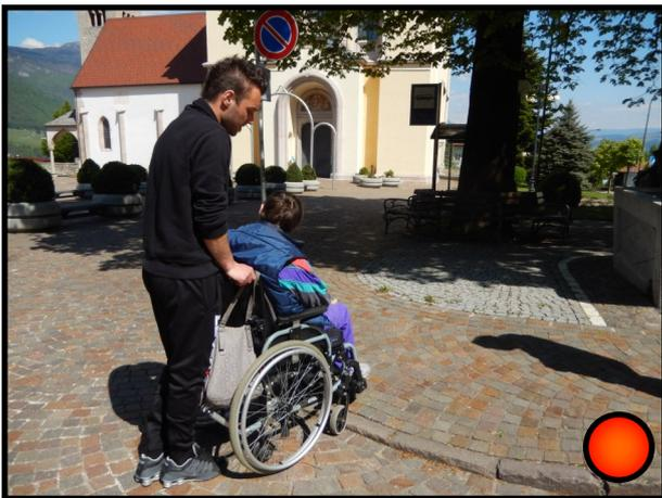
La pavimentazione della strada e del marciapiede è in ottime condizioni. Troviamo qualche difficoltà a salire sul marciapiede a causa di un piccolo scalino di 3 cm.
